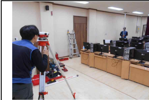
지상1층 상부 부재 수직 변위 조사 현황
